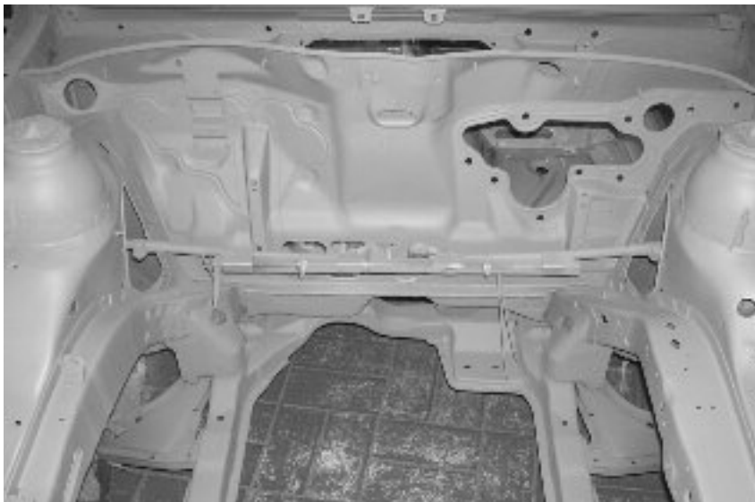
Die Stirnwand, grundiert
