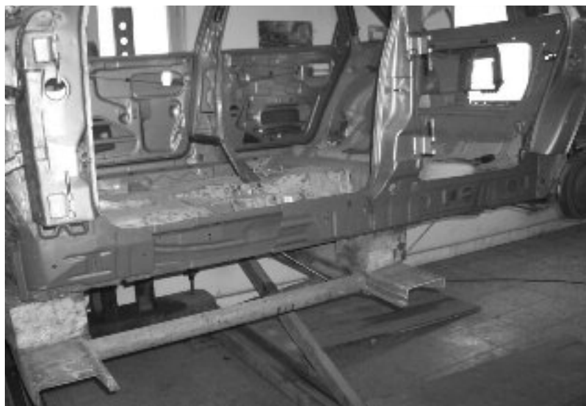
Der Innenschweller, in Arbeit
