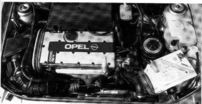
Charakteristika des Zweiliter-Turbomotors: Vierventil-Zylinderkopf, in den Auspuffkrümmer integrierter Lader und Ladeluftkühlung
