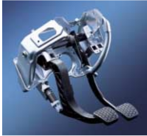
Auskuppelnde Pedale (PRS) werden bei einer schweren Frontkollision aus den Lagern freigegeben und vermindern so die Gefahr von Fuß- und Beinverletzungen.
