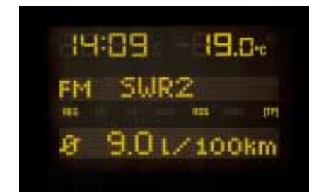
◻◻ Board Info Display (BID) zeigt aktuell wichtige Informationen wie Kraftstoffstand, Durchschnittsgeschwindigkeit oder Entfernung zu einem eingegebenen Ziel.
