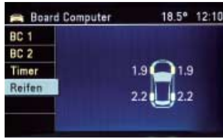
○△□ Das Reifendruck-Kontrollsystem: Bei Druckverlust erhalten Sie im Display des Drehzahlmessers eine Warnung. Im Graphic Info Display (GID) bzw. im Color Info Display (CID) wird der Druckverlust mit Angabe des entsprechenden Rades angezeigt. Sie können über diese Displays auch jederzeit den aktuellen Reifendruck abfragen.
