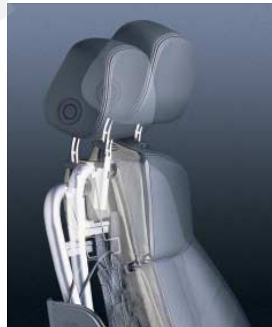
Entscheidendes Sicherheitsplus in den Vordersitzen. Neue aktive Kopfstützen mit Lehnenunterstützung reduzieren das Risiko von Nackenverletzungen ganz erheblich.
