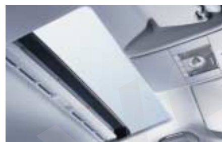
○△□ Das elektrische Schiebe-/Ausstelldach mit Positionsvorwählschalter und Einklemmschutz lässt sich auch per Funkfernbedienung schließen.
