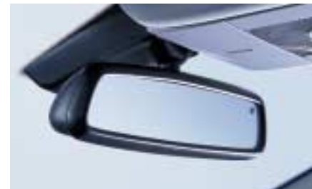
○△■ Der automatisch abblendende Innenspiegel dämpft die Scheinwerferreflexionen des folgenden Fahrzeugs auf ein augenfreundliches Niveau ab. Eine weitere Entlastung der Augen bewirkt das Automatische Abblendlicht (ALC), das auf wechselnde Lichtverhältnisse reagiert. Der Regensensor erkennt die Wassermenge auf der Windschutzscheibe und reguliert automatisch die Scheibenwischgeschwindigkeit.
