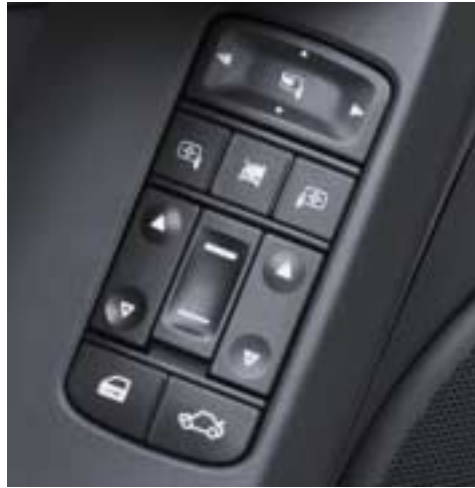
Serienmäßig im Vectra Elegance. Elektrische Fensterheber vorn und hinten mit Tippfunktion und Einklemmschutz.
