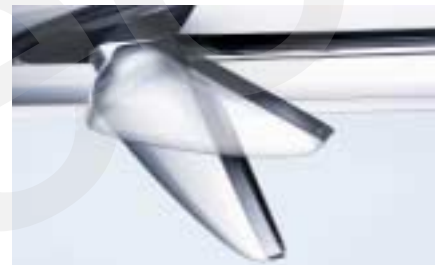
○△□ Die Außenspiegel lassen sich auf Knopfdruck an die Karosserie anklappen. Die Spiegeleinstellung bleibt nach dem Ausklappen erhalten.
