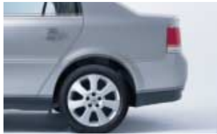
○△□ Die Niveauregulierung. Abhängig von der Zahl der Insassen oder der Zuladung wird das Heck des Opel Vectra automatisch höhenreguliert.
