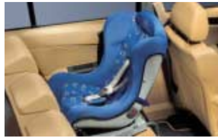
○△□ Ihren Kindern steht bestmögliche Sicherheit zu. Dem entspricht der Opel TOPSAFE ISOFIX, durch den die Kindersitze fest mit der Karosserie verkoppelt werden.
