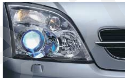
○△□ Adaptives Fahrlicht (AFL), eine wegweisende Scheinwerfer-Technologie, die bei schlechten Sichtverhältnissen und bei Nacht ein deutliches Plus an aktiver Sicherheit bietet.
