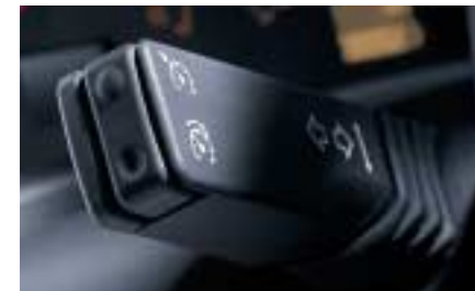
○△□ Der elektronische Geschwindigkeitsregler arbeitet zusammen mit dem elektronischen Gaspedal des Opel Vectra besonders genau und speichert die Geschwindigkeit für entspanntes Fahren.
