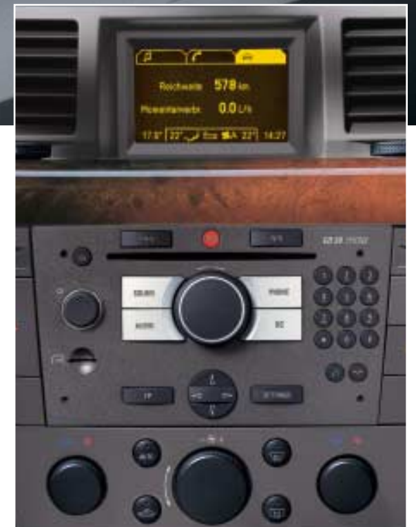
○△□ Hightech-Alternative. Die hochpräzise Klimatisierungsautomatik mit Temperaturvorausberechnung und getrennter Regelung für Fahrer- und Beifahrerseite. Spezielle Funktionen werden über das monochrome Graphic Info Display (GID) oder optional über das farbige Color Info Display (CID) eingestellt.
