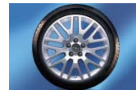
○□ Die Leichtmetallräder 7 1/2 J x 18 im Y-Speichen-Design mit Reifen 225/45 einschl. Sportfahrwerk und 20 mm tiefer gelegter Karosserie (nicht mit Niveauregulierung).
