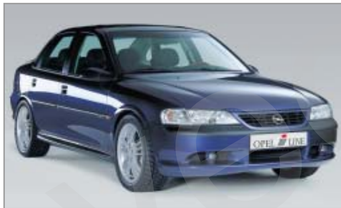
Spoilerstoßstange (bis Mj. 99,5) i 29 01 001, Seitenschweller (bis Mj. 99,5) i 29 01 311, Leichtmetallräder im Spectra Line-Design.
