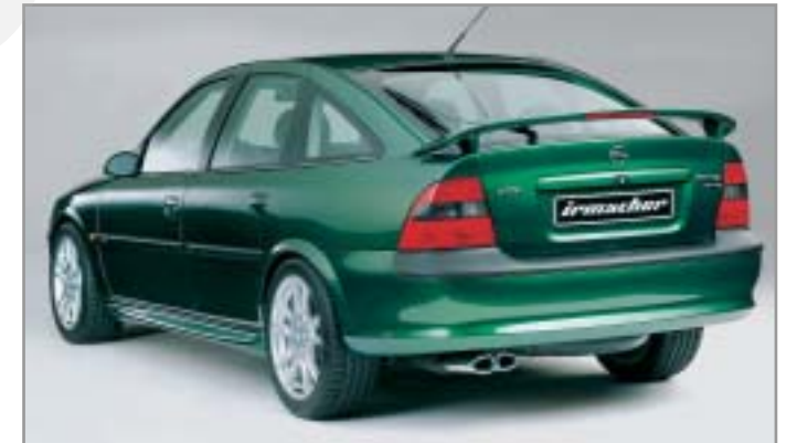
Heckflügel i 29 01 406 mit integrierter 3. Bremsleuchte (bis Mj. 99,5), Seitenschweller (bis Mj. 99,5) i 29 01 311, Nachschalldämpfer (bis Mj. 99,5) i 29 08 041/043, Leichtmetallräder im Twin Spoke-Design.
