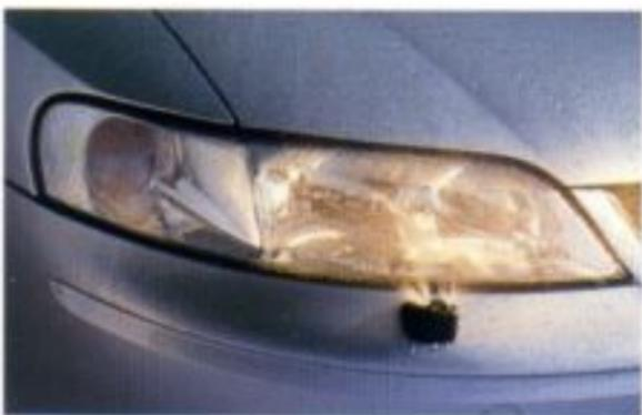
Erhöhte Sicherheit bei Nacht: Xenonscheinwerfer mit Hochdruck-Reinigungsanlage und dynamischer Leuchtwertenregulierung.
