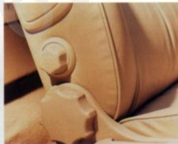
*Mit der individuell einstellbaren Lordosestütze wird der Lendenwirbelbereich gezielt gestützt und entlastet.*
