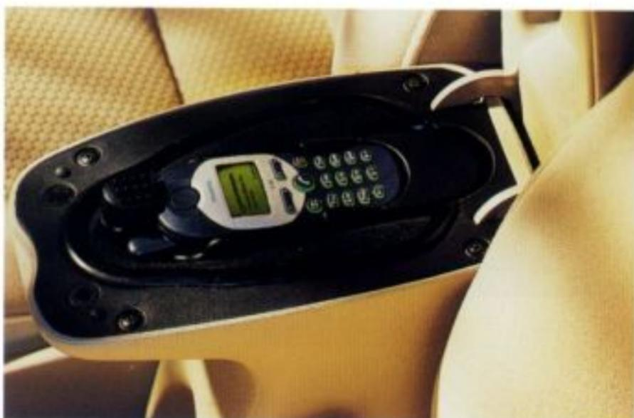
Telefoneinbausatz mit Sprachsteuerung: Siemens professional Voice System, hier einschl. Siemens Handy C35i. Lieferbar in Verbindung mit Radios CAR 400, CDR 500, CCR 600 und NCDR 1100.
