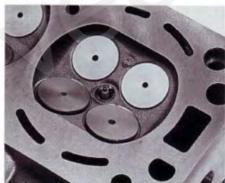
Durchzugstark und ökonomisch. Die 4-Ventil-Technik der ECOTEC-Motoren mit zentral platzierter Zündkerze.
