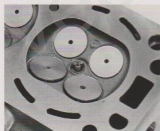
Drehzugstark und ökonomisch. Die 4-Ventil-Technik der ECOTEC-Motoren mit zentral platzierter Zündkerze.
