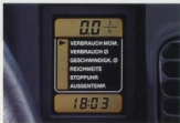
Bordcomputer mit allen wichtigen Funktionen wie z. B. durchschnittlichem Verbrauch seit Fabrikatritt, Reichweite, Außentemperatur oder Uhrzeit.
