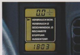
Bordcomputer mit allen wichtigen Funktionen wie z. B. durchschnittlichem Verbrauch seit Fahrtantritt, Reichweite, Außentemperatur oder Uhrzeit.
