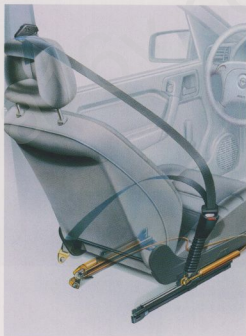
Das Vectra-Aktivgurt-System mit Gurtstraffer, höhenstellbaren 3-Punkt-Sicherheitsgerten vorn und hinten und in die Sitzstruktur integrierten Sitzrampen.
