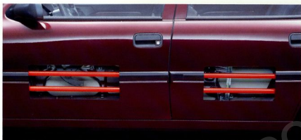
Eine integrierte Doppel-Stahlrohrverstärkung sorgt für Rundumschutz und effektiven Flanken-schutz bei seitlichen Kollis-sionen.
