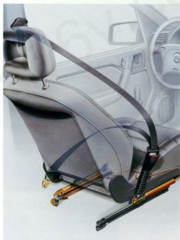
Das Vectra-Aktivgurt-System mit Gurt-straffer, höheninstell-baren 3-Punkt-Sicher-heitsgarnen vorn und hinten und in die Sitz-struktur integrierten Sitzrampen.
