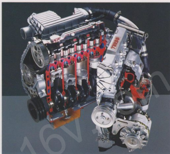
Stark und sauber: der 1.7i-Turbodiesel mit Intercooler.
