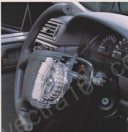
Der zusammengefaltete Airbag im Pralltopf des Lenkrads.
