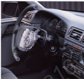
Der zusammengefaltete Airbag im Pralltopf des Lenkrades.
