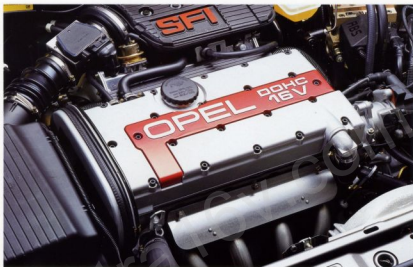
Der 2.0i-16V-Motor, 110 kW (150 PS).
