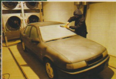
Kältekammer: Auf minus 30 Grad werden die Testautos „tiefgefroren“
