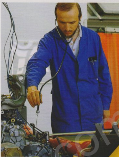
Horchposten: Lagerschäden mit dem Stethoskop auf der Spur
