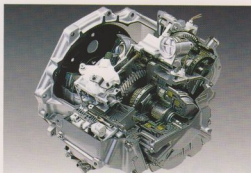
Vollelektronisch gesteuerte 4-Stufen-Automatic. Wahl zwischen den Fahrprogrammen „Economy“ und „Sport“. Zusätzliche Anfahrhilfe durch „Winter“-Schaltung.
