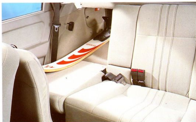
Asymmetrisch geteilte, umklappbare Rücksitzbank mit Durchladeeinrichtung.
