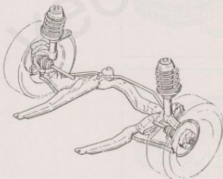
**Hinterachse:** Verbundenker-Hinterradaufhängung mit doppelkonischen Miniblockfedern. Erhöhter negativer Radsturz für guten Geradeauslauf.
