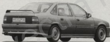
Serie 1: GFK-Anbauteile, Flügel à la M 3, geschlitzte Heckschürze.
