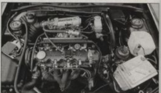
Das Kraftpaket: 170 PS holt Tuner Mantzel aus dem Zweiliter-Einspritzer heraus. Aber erst ab 4500 Touren geht die Hölle los.
