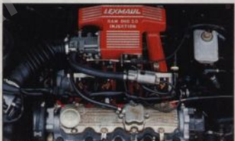
Auf der IAA erstmals gezeigt: Rotlackierter, mit Rippen überzogener Ansaugkasten beim Lexmaul-Vectra mit Stoßaufladung.
