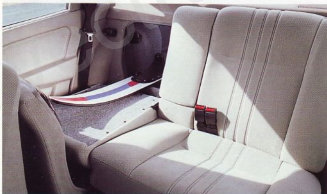
Asymmetrisch geteilte, umklappbare Rücksitzbank mit Durchladeeinrichtung hinter der Mittelarmlehne.
