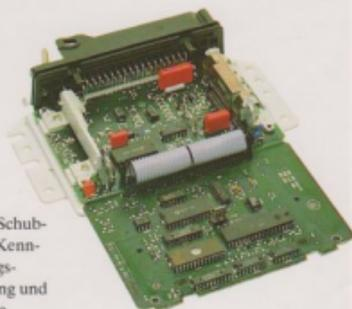
Bosch-Motronic ML 4.1 mit Schubabschaltung, elektronischer Kennfeldzündung, Leerlaufüllungsregelung, Drehzahlbegrenzung und elektronischer Selbstdiagnose.
