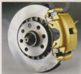
Diagonales Zweikreisbremsensystem mit Bremskraftverstärker und Bremskraftregler. Bei 1.6i- und 1.7D-Motoren Scheibenbremsen vorn und Trommelbremsen hinten; bei 2.0i-Motor Scheibenbremsen vorn und hinten (vorn innenbelüftet). Asbestfreie Bremsbeläge.
