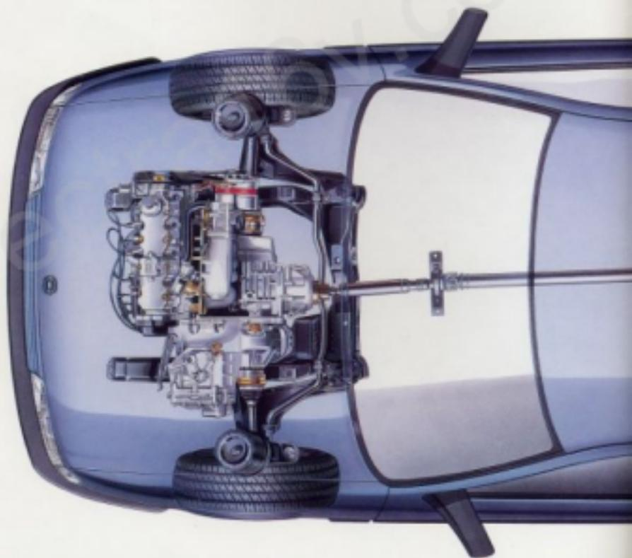
Die vollautomatische Abschaltung erfolgt durch eine hydraulische Lamellenkupplung, die im Verteilergetriebe integriert ist. Eine weitere Besonderheit dieses Getriebes ist die Viskose-Kupplung, die selbständig das Antriebsmoment zur Hinterachse regelt - je nach Straßenzustand und Beladung des Fahrzeuges.
