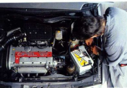
Horchposten: Meßfühler übertragen Motordaten zum Computer
