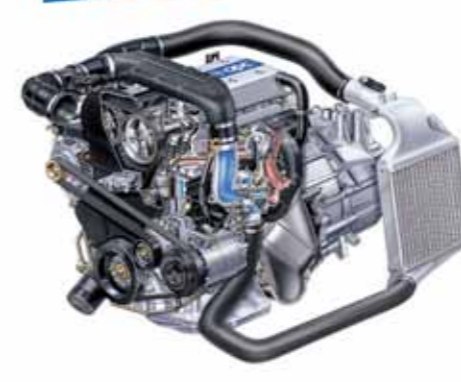
Eines der typischen Merkmale von OPC-Motoren ist die Turboaufladung. Der Vorteil sind hohe Literleistungen (siehe Technische Daten Seite 67) bei vergleichsweise kleinen Hubräumen. So besitzt der 240 PS starke 2,0-Liter-Turbomotor des Astra und Zafira OPC eine höhere Literleistung als ein Ferrari F430
