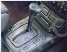
Zur Wahl steht bei der VIERSTUFEN-AUTOMATIK ein Sportmodus, in dem für schnelles Beschleunigen erst später hochgeschaltet wird
